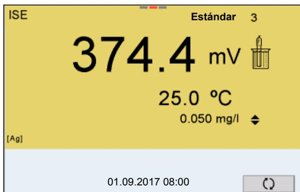
18. Con **<ENTER>** continuar con la calibración de 3 puntos.
