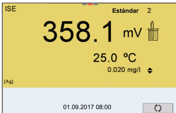
**Continuar con la calibración de dos puntos**
