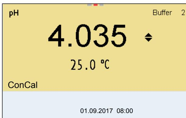
17. Con **<▲><▼>** ajustar el valor nominal de la solución tamponada correspondiente a la temperatura medida.
