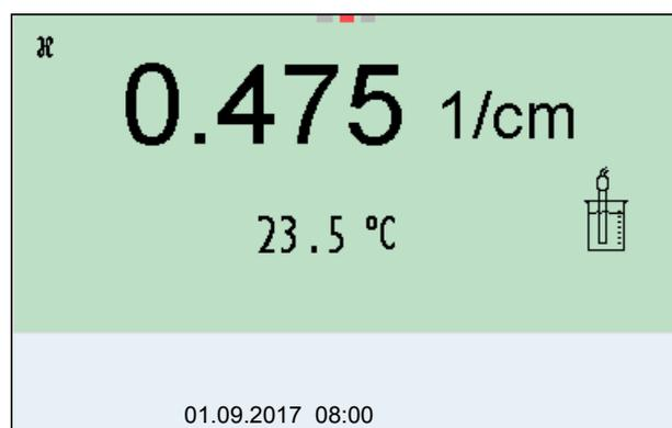
4. Sumergir el sensor conductímetro en la solución de control estándar 0,01 mol/l KCl.
