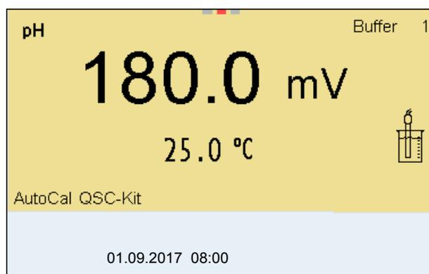
3. La calibración con la solución tamponada del juego QSC es similar a la calibración de tres puntos normal. Siga las instrucciones para el usuario.
