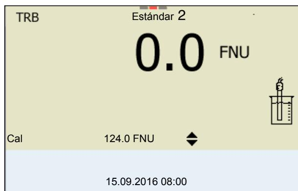
**Continuar con la calibración de dos puntos**
