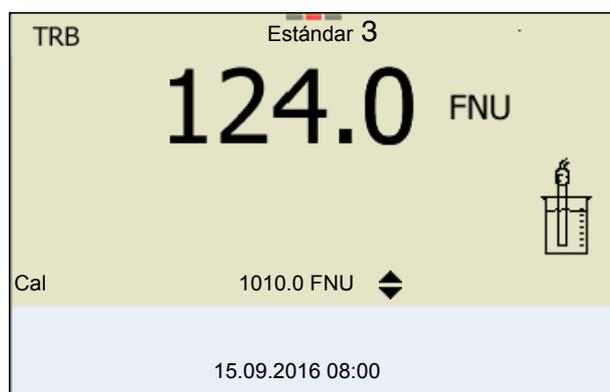
16. Con <M> finalizar la calibración como calibración de dos puntos. Aparecen los nuevos valores de calibración. o bien, Seguir con la calibración de tres puntos.
